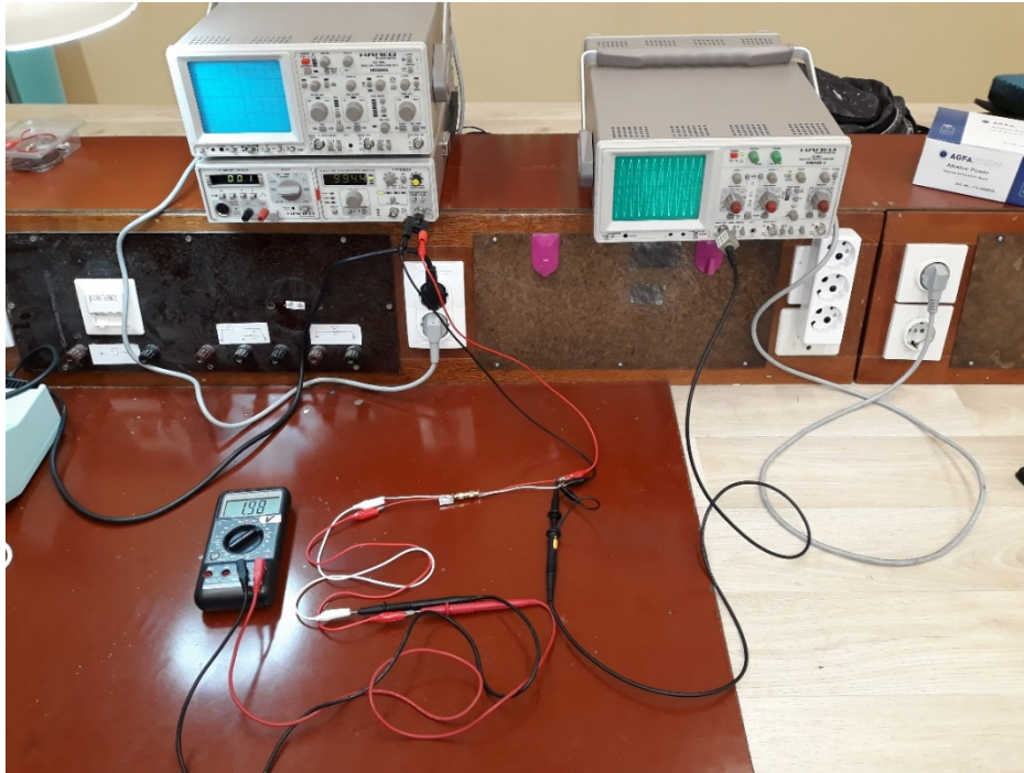
Слика 5.4. Мерна поставка прототипа диодног детектора.
