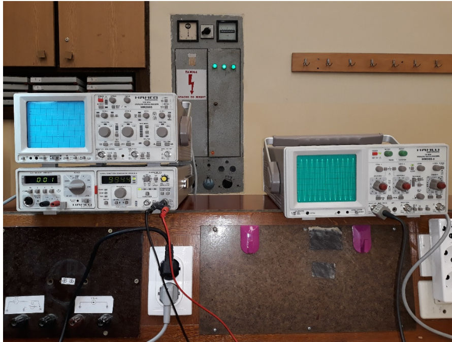
Слика 5.3. Изглед мерне поставке са генератором сигнала (лево) и осцилоскопом (десно).
