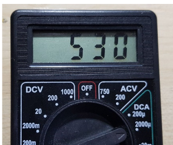
Слика 30. Потрошна струја Node система у sleep режиму изражена у \mu\text{A} .
